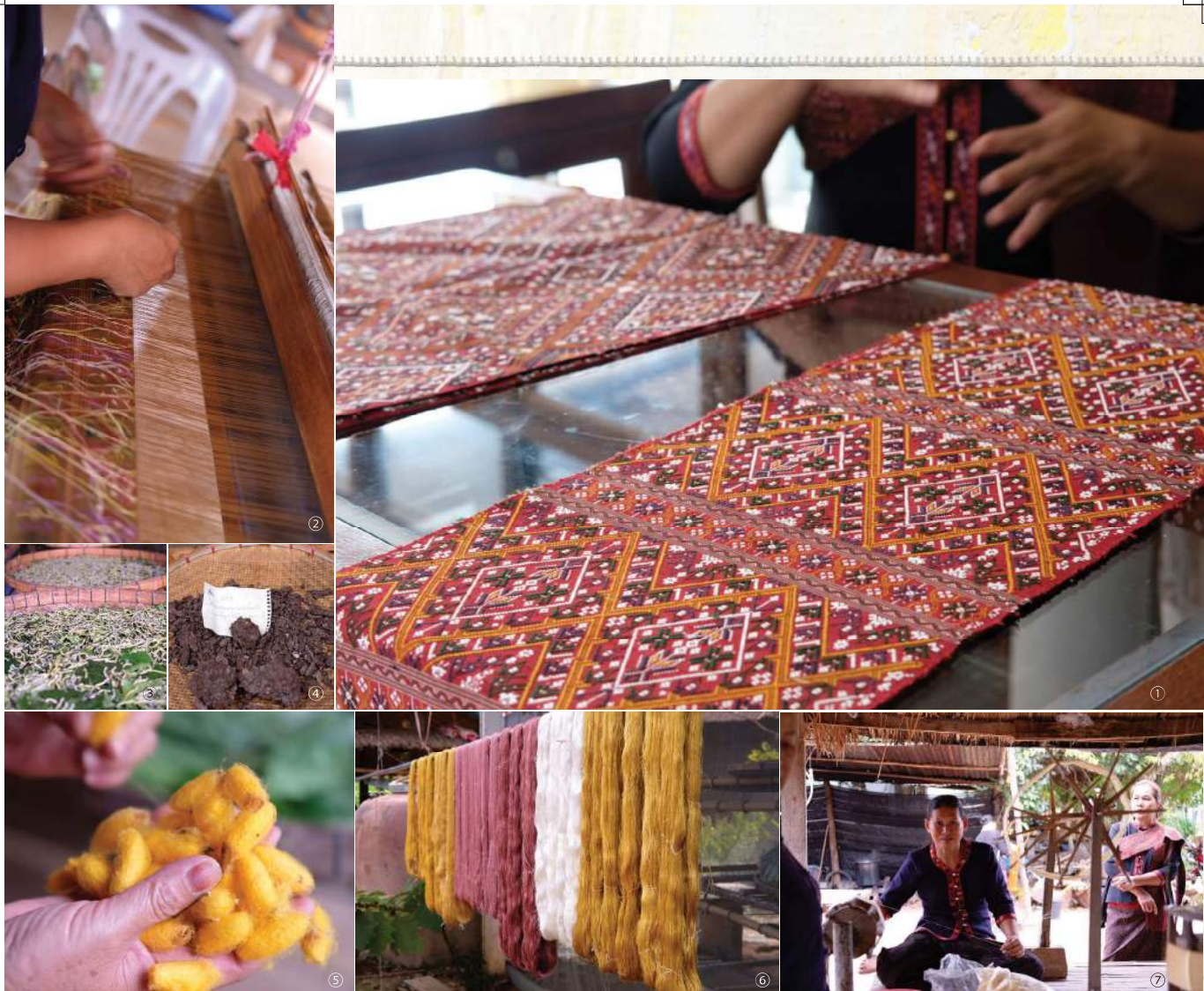
①着物の帯のような風格の「プレーワー」 ②織るときに見えるのは裏面。難易度が高い ③食欲旺盛な蚕。桑を食む音が聞こえる ④印象的な赤色はクランという小さな虫由来の染料で染める ⑤タイの繭は黄色くて日本の繭より細長い ⑥白い糸は一般的なタイ蚕とは別品種の蚕で飼育が難しい ⑦糸になるまでには多くの工程をふむ
